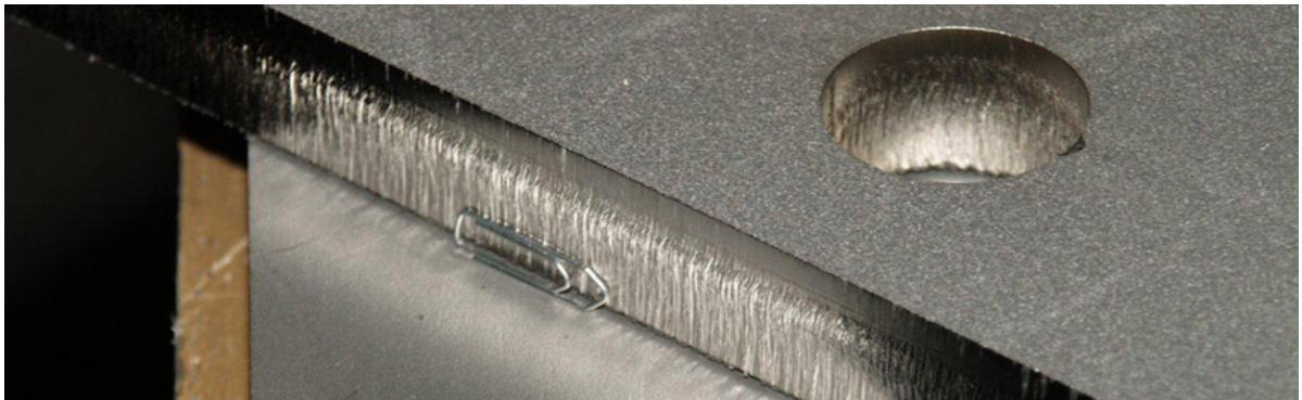
Рис. 14: Металлический лист, разрезанный лазером.
