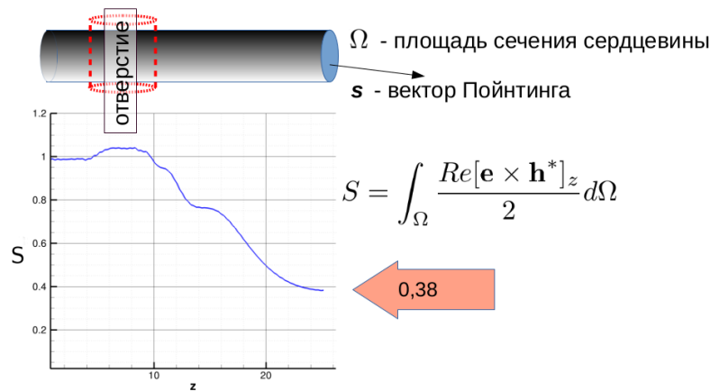
Рис. 38: Зависимость потока вектора Пойнтинга через поперечное сечение сердцевины оптоволокна от координаты вдоль оптоволокна в задаче с цилиндрической полостью.
