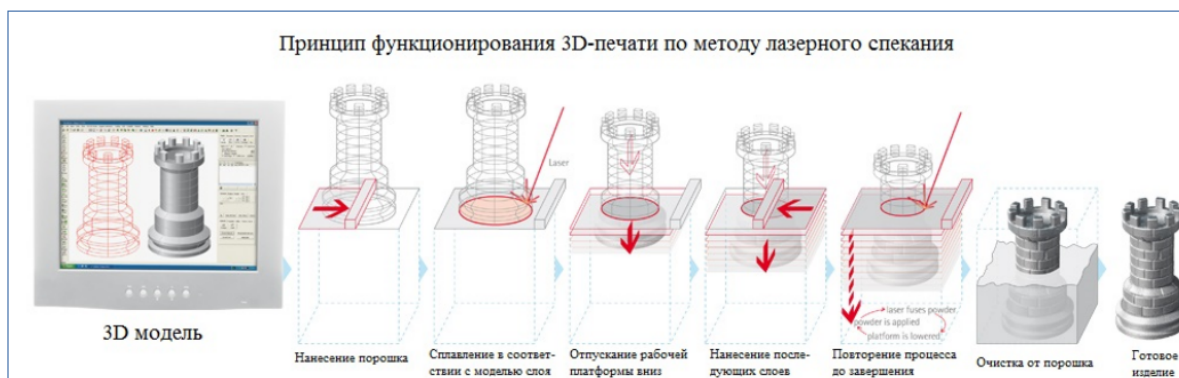
Рис. 24: Схема технологии 3D-печати методом селективного лазерного спекания
