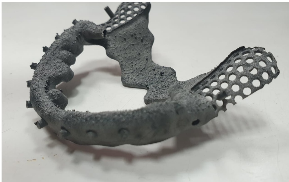
Рис. 23: Стоматологическое изделие, выполненное селективным лазерным спеканием
