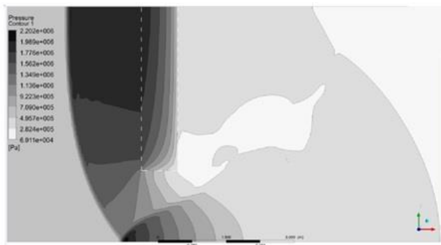
Рис.15 Поле давлений после отражения ударной волны от проницаемой преграды. Перемещающаяся область аномального давления вблизи правого борта выработки
