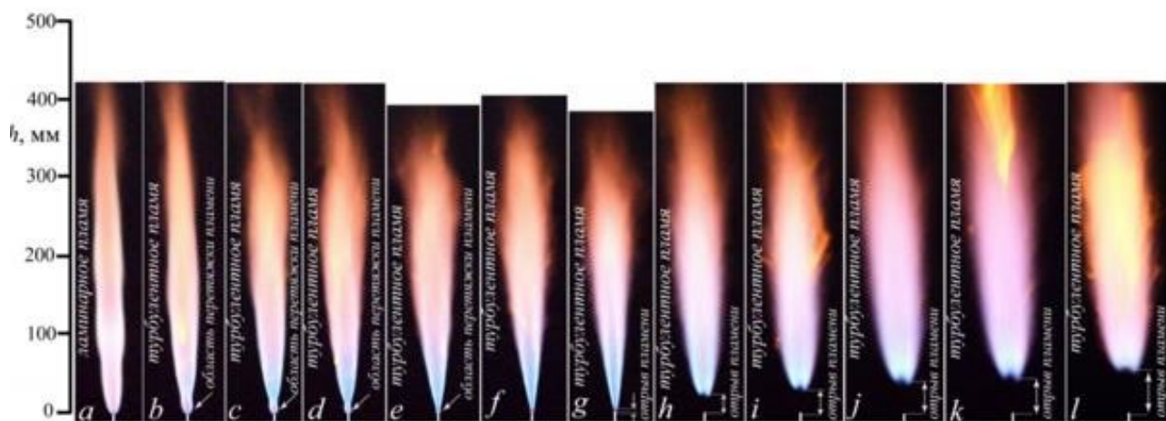
Рис. 19. Фотографии пламени при диффузионном горении микроструи водорода, истекающей из круглого сопла с d = 1200 мкм при увеличении скорости истечения: a-h - от 40 до 1340 м/с [23]
