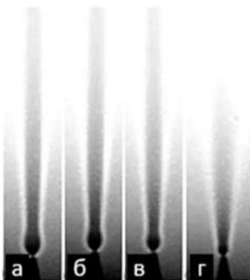
Рис. 16. Теневые картины процесса диффузионного горения микроструи, истекающей из сопла с d = 30 мкм [22]
