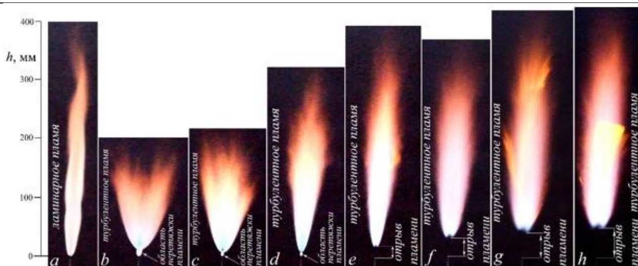
Рис. 29. Фотографии пламени при диффузионном горении микроструи водорода, истекающей из плоского ( l = 2,45 мм, h = 0,37 мм) микросопла в ситуации нарастания скорости ее истечения: а-г - значение U_0 от 40 до 1340 м/с, вид с узкой (h) стороны микросопла [32]
