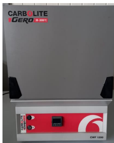
Рисунок 2.10 – Фотография камерной печи Carbolite, оснащенной контроллером температуры
