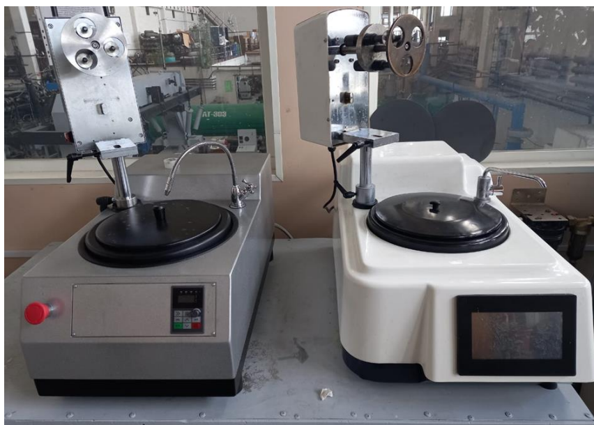
Рисунок 2.13 – Фотография системы пробоподготовки.
