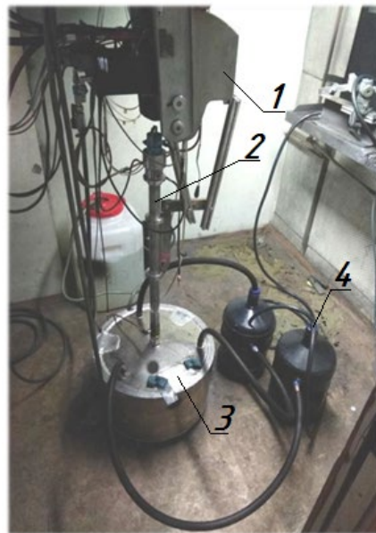
Рис. 5.1.3. Общий вид лабораторного ИГДА: 1 – газораспределитель, 2 – ствол, 3 – первая ступень уловителя частиц, 4 – вторая ступень уловителя частиц.
