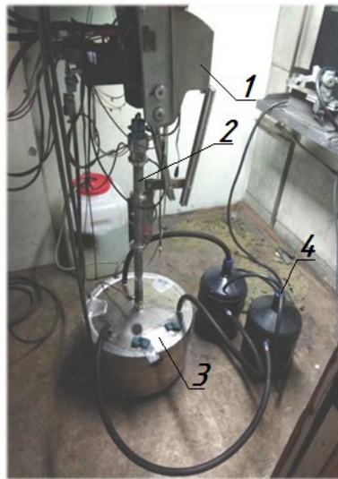
Рис. 4. Общий вид лабораторного ИГДА: 1 – газораспределитель, 2 – ствол, 3 – первая ступень уловителя частиц, 4 – вторая ступень уловителя частиц.
