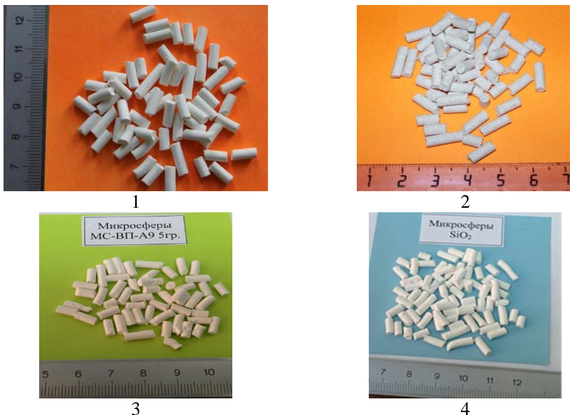
Рис. 1.7. Фотографии образцов композитных сорбентов на базе различных исходных полых микрочастиц.
