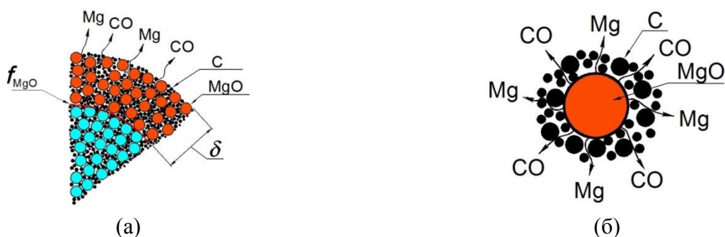
Рис. 1.66 Схематическое представление процесса карботермического восстановления магния при плазменной обработке агломерированных частиц MgO+C. (а) - фрагмент поперечного сечения агломерата, (б) - реагирование одиночного включения MgO в приповерхностном слое агломерата.
