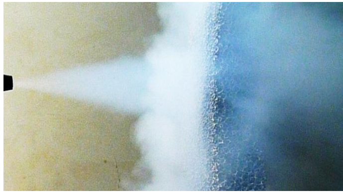
Рис. 3.1-12 Натекание водяного пара
