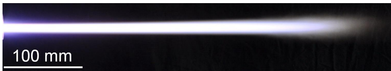
Рис. 1.52 Оптическая фотография аргон-азотной квазиламинарной плазменной струи.
