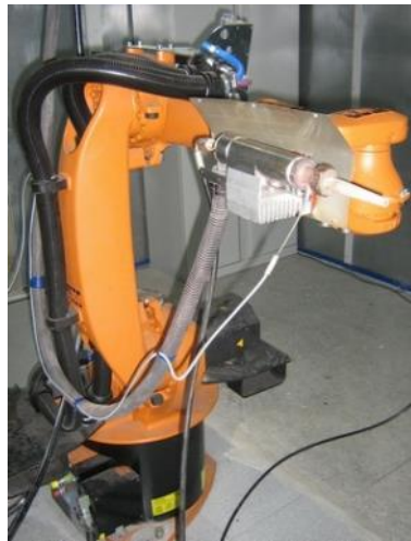
Рис. 2.3.2 Робот KUKA KR 16-2 с закрепленным на нем узлом ХГН.
