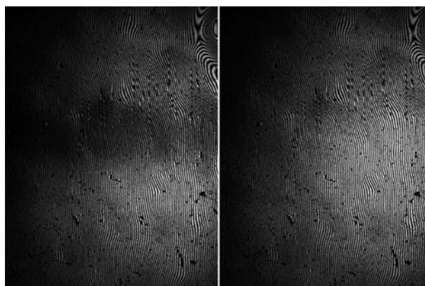
Рис. 1.15. Визуализация теплового потока на плоской поверхности при сверхзвуковом режиме обтекания. Слева – за турбулизатором (пунктиром указано местоположение следа). Справа – для модели без турбулизатора (для сравнения)
