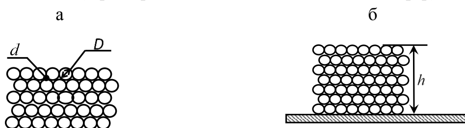
Рис. 31. Схематическое представление пористой и шероховатой вставок. (а) вид в плане, (б) поперечное сечение.
