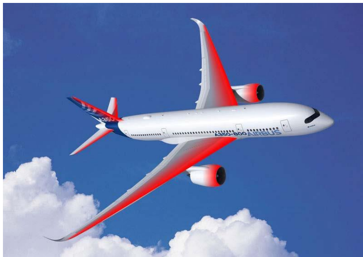
Рис.2.1.1. Область возможной «естественной» ламинаризации пограничного слоя.
