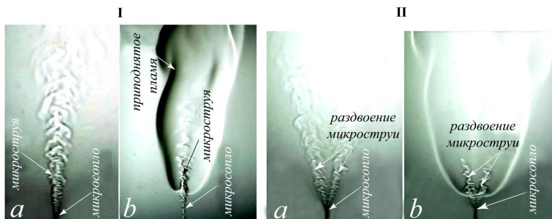
Рис. 2.10.4. Теневые картины диффузионного горения турбулентной круглой микроструи пропана: I – без акустического воздействия ( a - без горения, b – с горением); II – с акустическим воздействием на f = 4,5 кГц ( a – без горения, b – с горением); U_{\text{микроструи}} = 12 м/с.
