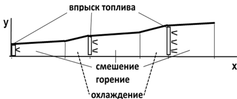
Рис.11. Функциональная схема камеры сгорания ГПВРД
