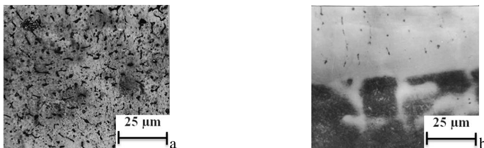
Рис. 2.2.4. Строение карбидной фазы наплавленного покрытия Р6М5 при лазерной наплавке в несколько проходов.
