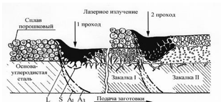
Рис.2.2.3 Схема многослойной наплавки
