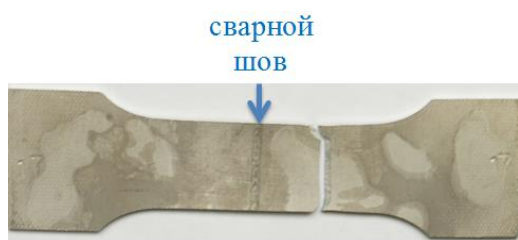
Рис. 2.1.3 Разрушение по основному сплаву Прочность шва выше прочности сплава!
